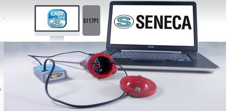
La configurazione dei trasmettitori T120 e T121 può avvenire tramite lo strumento EASY USB, che converte il segnale seriale dall'USB del PC in un segnale seriale UART TTL e viceversa, e software EASY LP. Il modulo può essere configurato anche se non alimentato dal loop 4..20 mA, traendo alimentazione tramite il connettore di programmazione.
